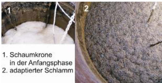
Abbildung 56: Schäubildung in der Anfangsphase und adaptierter Schlamm
