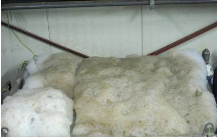
Abbildung 47: Schaumprobleme in der Einfahrphase
