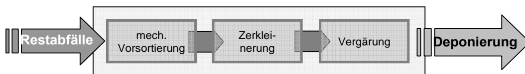
Abbildung 88: Verfahrensschritte 1 zur Aufbreitung häuslicher Restabfälle in China
